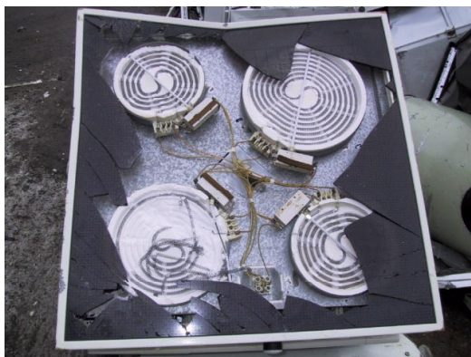
Bild 1. Eldfasta keramiska fibrer finns i många produkter. På bilden en sönderslagen keramisk spishäll. Eftersom plattan är sönderslagen syns de fyra plattornas spiralformade värmetrådor. I denna spis ligger varje värmetråd i en skål av eldfasta fibrer.
