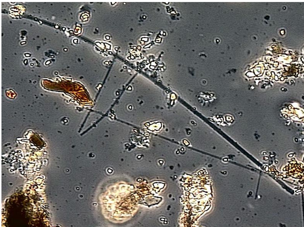
Bild 2. Luftprov taget med provtagningsutrustning buren av en ugnsmurare i samband med isolering av en smältugn med eldfasta keramiska fibrer (RCF). De "svarta långa strecken" är keramiska fibrer. Bilden tagen i ljusmikroskop vid 100 gångers förstoring. Bild: Lennart Lundgren (ITM).
