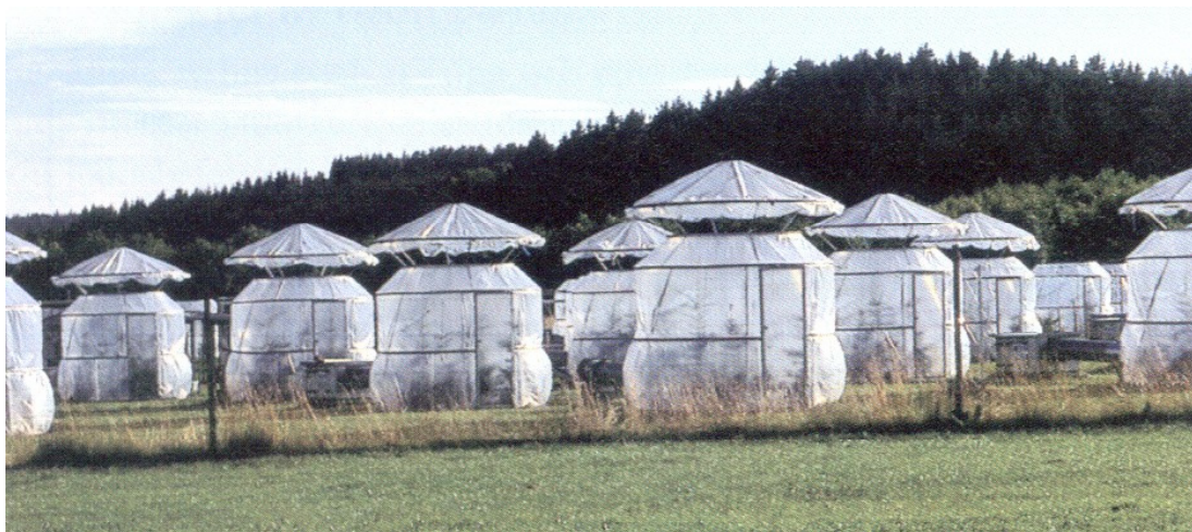
Figur 11. Ett fotografi av en del av de fältkammare som använts för experiment med ozon vid Östads Säteri. Kamrarna är ca 3 m i diameter och 2.5 m höga. En fläkt till varje kammare blåser in luft genom en perforerad innervägg dygnet runt. Luften kan filtreras från ozon eller tillsätts extra ozon.
