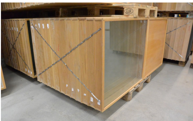
Figur 3. Säkring ("kryssning") av glaspartier med hjälp av hårt spänt montageband.
