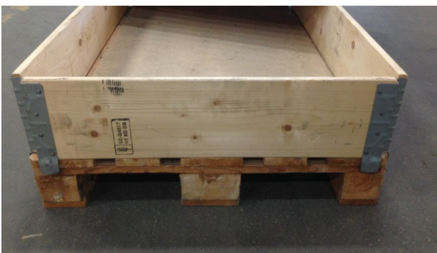
Figur 5. Pallkragar för att kunna stapla flera lager ovanpå varandra
