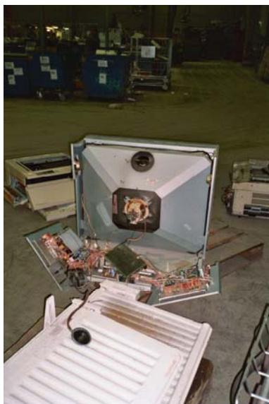
Figur 4.3 Demontering av CRT-skärmar. Fotona visar att skärmarna innehåller en del kretskort och kablar.
