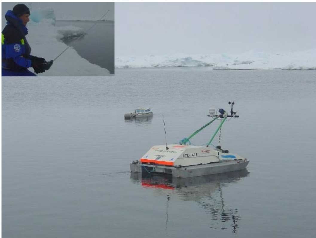
Bild 2. Radiostyrda ytfilmsinsamlare kan användas för insamling av större provvolymen med minimal risk för kontamination av proverna (bild från Arktis).
