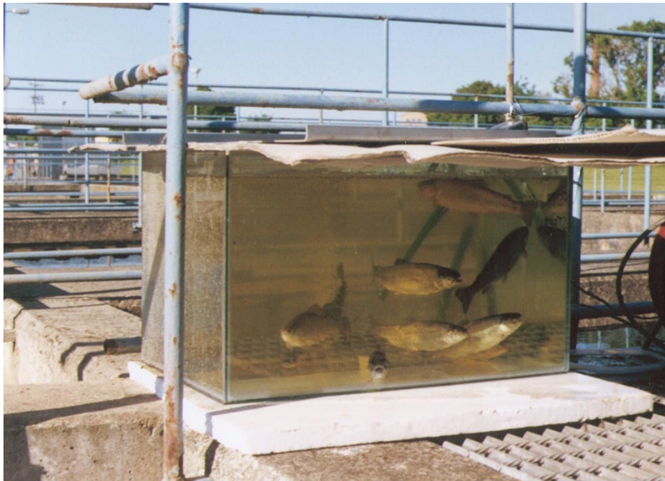
Fig. 3 Anordning för akvarieexponering av regnbåge vid ett av reningsverken.
